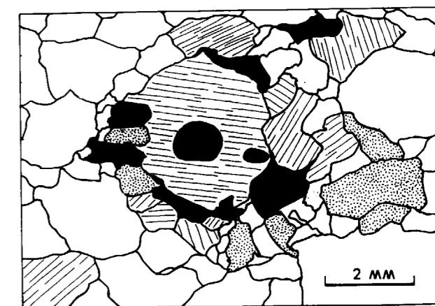
Figura 14.—Asociación de espinela (negro), ortopiroxeno (rayado) y clinopiroxeno (punteado) en una lherzolita de textura porfiroclástica. El olivino está en blanco. Sección XZ.
